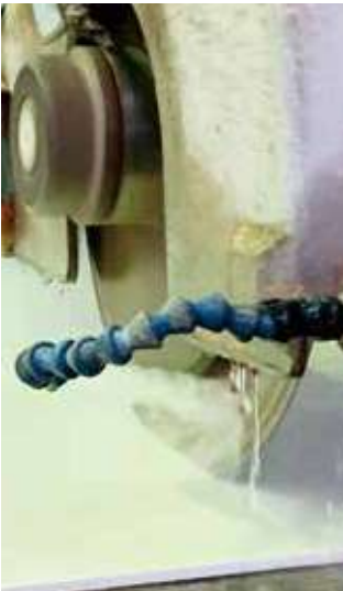
ブレードによる加工では切断面にチッピングが発生するため、糸面取り加工を施します。
