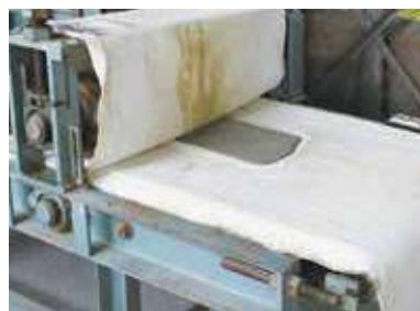
たたら成型機 粘土をローラーで 押しつぶすことで 板状に成形します。
