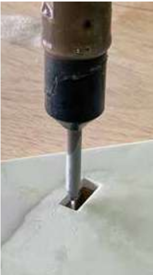
ウォータージェットマシンであれば丸穴だけでなく、角穴や曲線カットも可能です。
