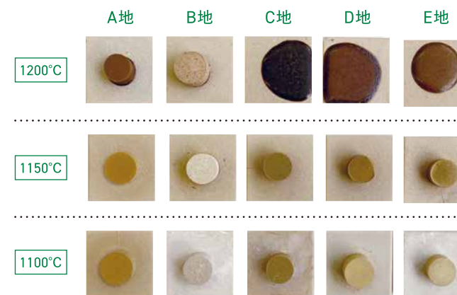
ボタン状ピースによる地域と焼成温度のテスト
